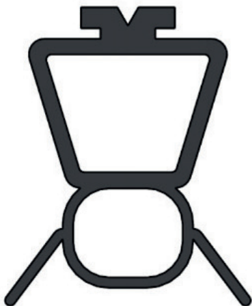
alte Ausführung der Dichtung (material EPDM) BAAN code: T09-020-20-0008
